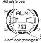
Alarm açık göstergesi
