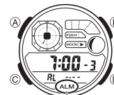
Alarm açık göstergesi
