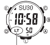
Otomatik Işık Anahtarı açık göstergesi
