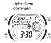
Alarm açık göstergesi
